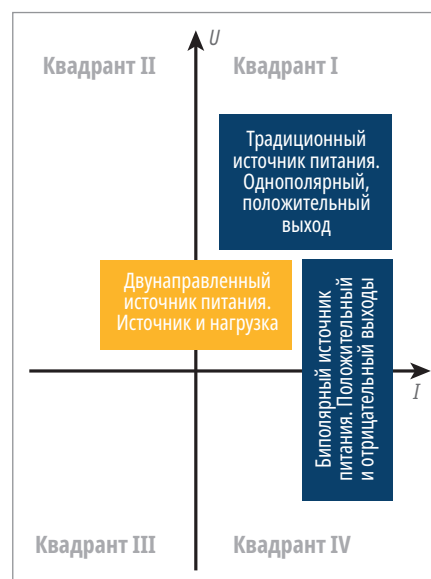
Рис. 2. Три типа источников питания постоянного тока
