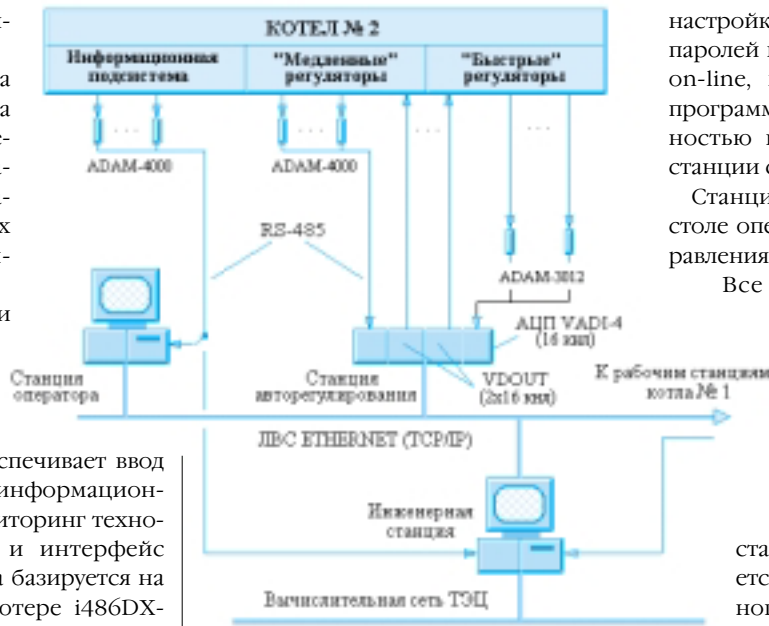
Рис. 1. Структурная схема информационно-управляющей системы парового котла
