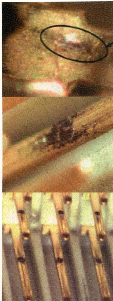
Рис. 1. Подгорание электрических контактов в стандартном соединителе ВКС
