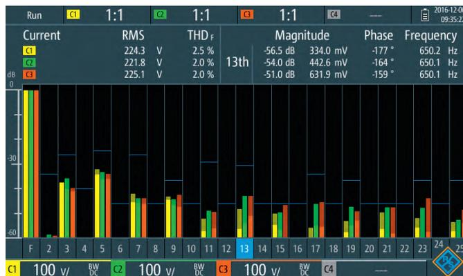
Рис. 5. Анализ гармоник трёхфазного сигнала напряжением 100 В
