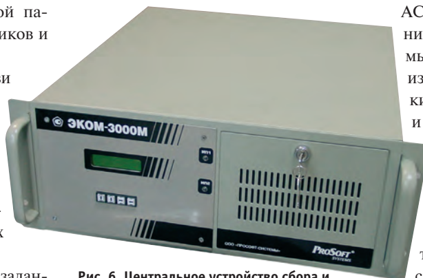
Рис. 6. Центральное устройство сбора и передачи данных ЭКОМ-3000М
