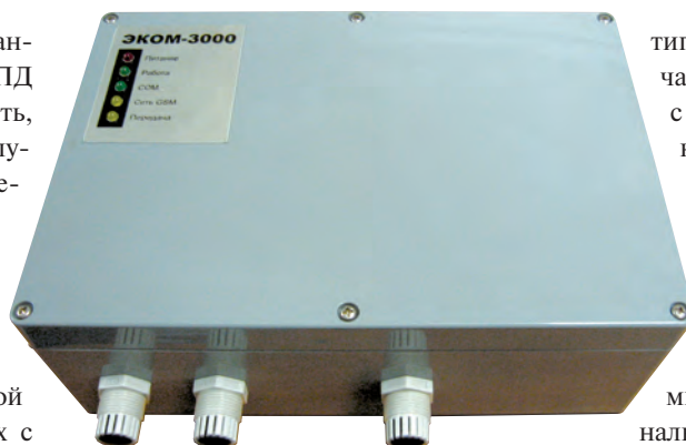
Рис. 5. Устройство сбора и передачи данных ЭКОМ-3000-ЛАЙТ
