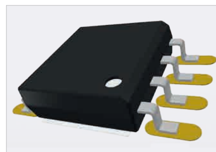
Рис. 7. ПМ с подключённой к нему 3D-моделью в STEP-формате
