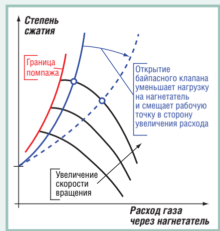
Рис. 2. ГДХ центробежного нагнетателя при управлении байпасным клапаном
