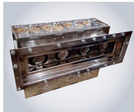
Рис. 7. Синхронизатор на четырёх магнетронах
