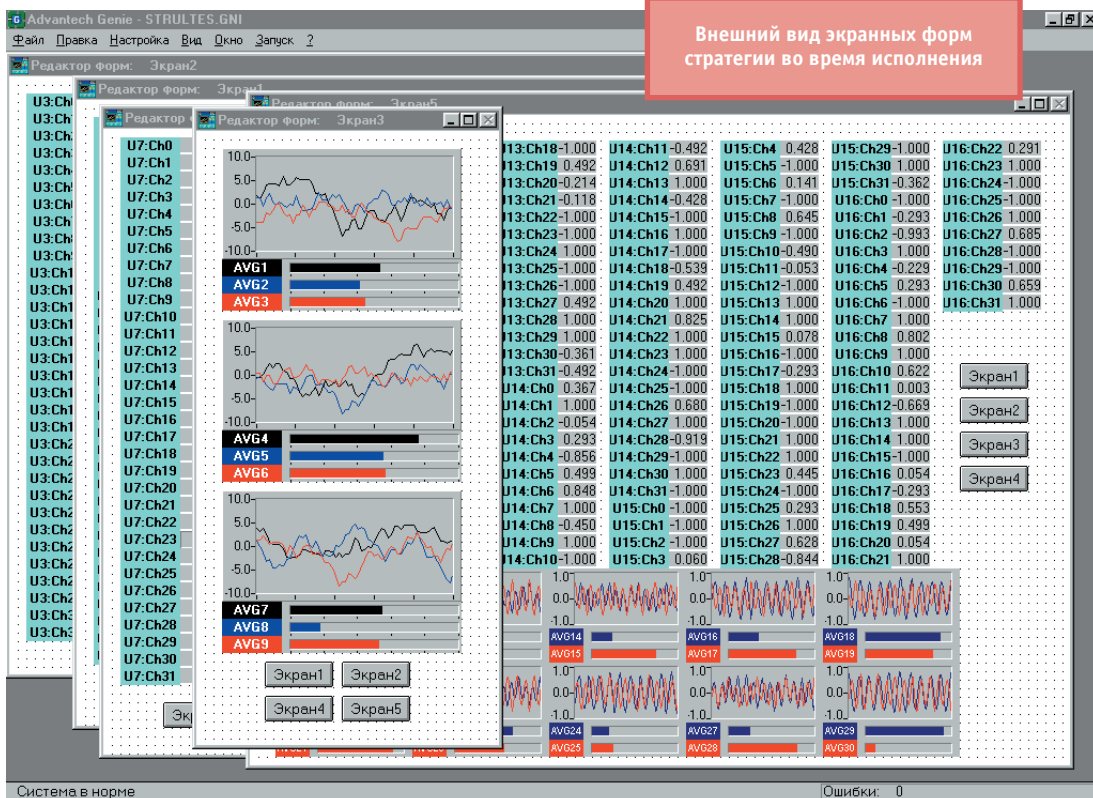
Рис. 12. Пример связи стратегии GENIE 3.0 с контроллерами, запрограммированными на UltraLogik. В стратегии выполняется прием 615 переменных
