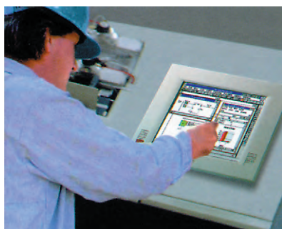
Рис. 11. Компьютер, смонтированный на панели
