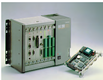
Рис. 11. Промышленный компьютер с фронтальным доступом к платам ISA (Advantech MIC-2000)
