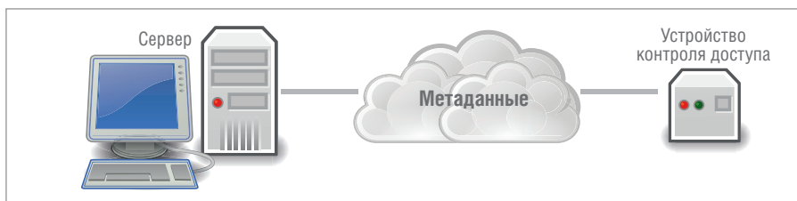
Рис. 4. Вариант анализа видеопотока на устройстве контроля доступа
