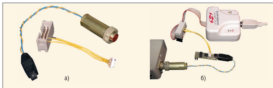
Рис. 12. Программирование микроконтроллера C8051F321 по интерфейсу C2 а) Кабели питания и сопряжения с адаптером USB-Debug, б) процесс программирования
