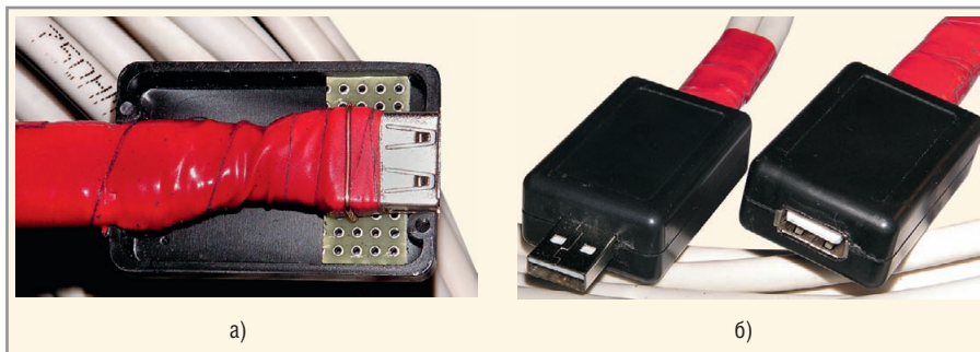
Рис. 14. Установка корпусов на разъёмы USB кабеля
