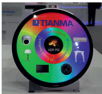
Рис. 4. Сенсорный дисплей круглой формы с вибрационной обратной связью Tianma Microelectronics
