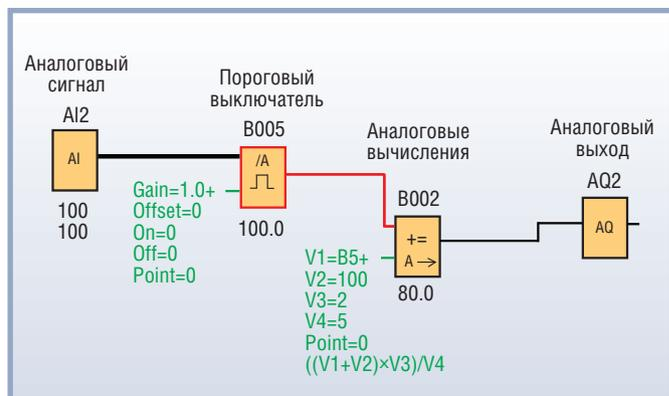
Рис. 4. Пример использования новой функции аналоговых вычислений
