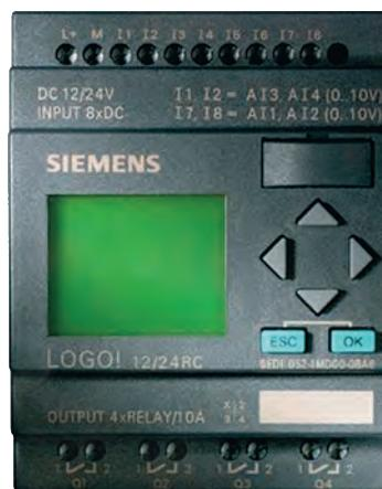
Рис. 1. Базовый модуль LOGO! 0BA6
