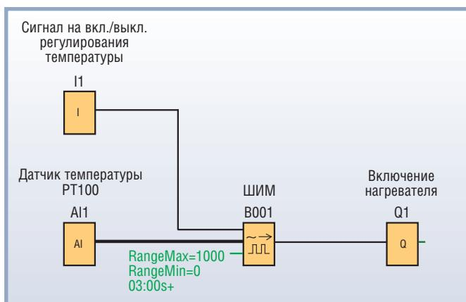
Рис. 3. Пример использования новой функции PWM (ШИМ)
