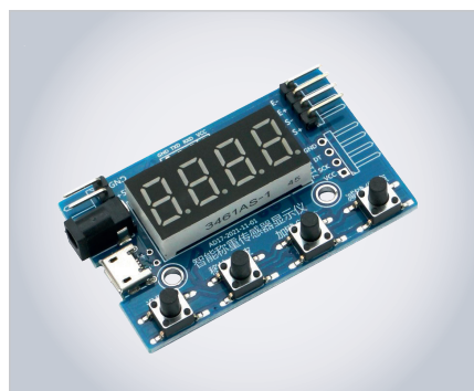
Рис. 18. Внешний вид модуль-контроллера весовых ячеек с индикатором
