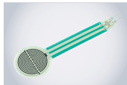
Рис. 5. FSR402 для измерений в диапазоне 0...10 кг
