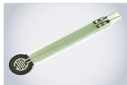
Рис. 6. Тензорезистор RFP602 для измерений в диапазоне 0...1 кг
