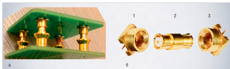
Рис. 1. Соединение печатных плат при помощи адаптеров «bullet» (а), сочетание соединителей SMPM (б): 1 – вилка с защёлкиванием, 2 – адаптер розетка-розетка «bullet», 3 – вилка для скользящего соединения
