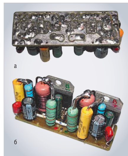
Рис. 10. Плата одного канала (B) мостового усилителя мощности: а) вид со стороны дорожек; б) вид с обратной стороны
