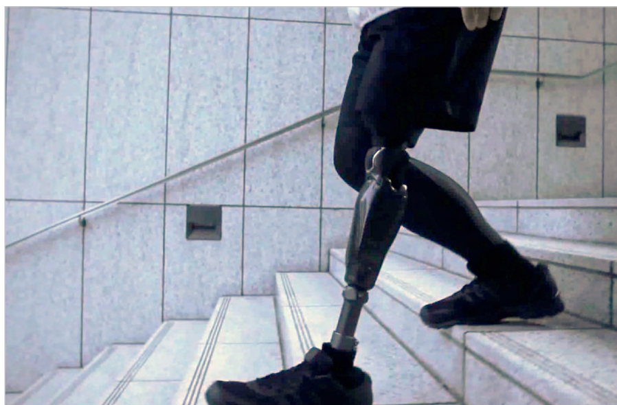
Рис. 2. Сенсорный ортопедический протез с датчиками фирмы Scaime
