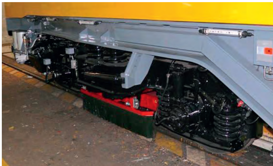
Рис. 3. Российская система контроля и диагностики МИБИС на колёсной паре локомотива DB (немецкие железные дороги)
