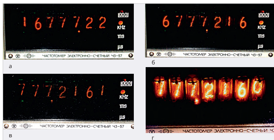
Рис. 8. Настройка кварцевого резонатора на частоту 16 777 216 Гц, а – T = 0,1 с; б – T = 1 с; в – T = 10 с
