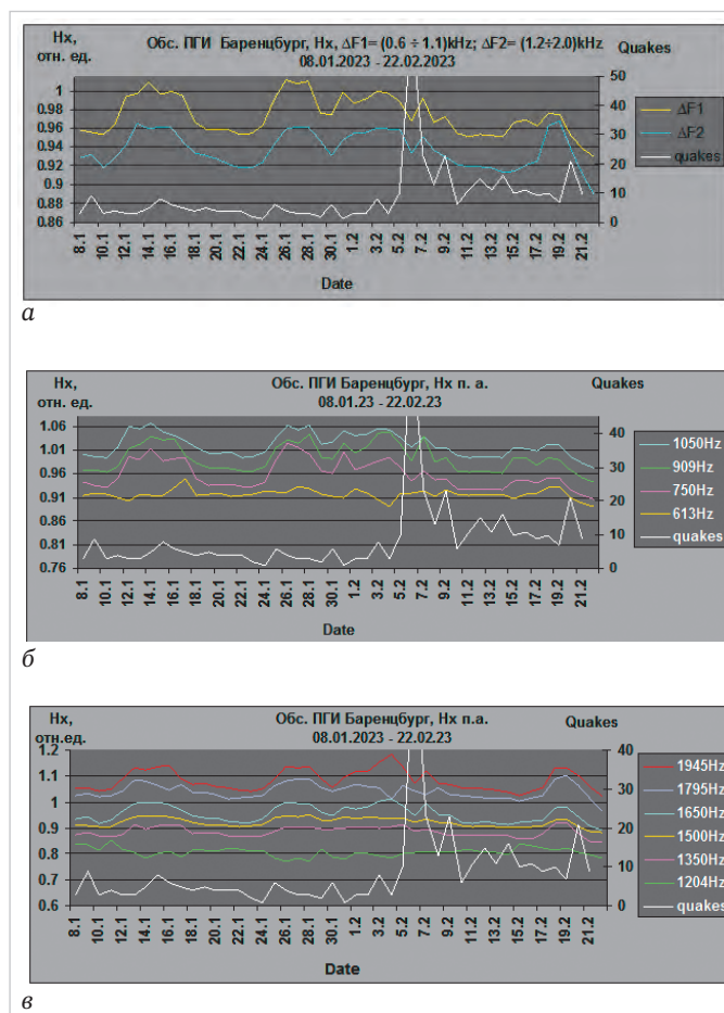
Рис. 7. Синхронная запись АЧХ магнитной H_x -компоненты поля атмосфериков (обс. ПГИ Баренцбург, арх. Шпицберген) и сейсмической активности (Kahramanmaraş, Turkey):
