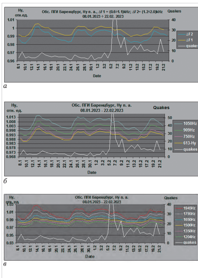
Рис. 8. Синхронная запись АЧХ магнитной H_y -компоненты поля атмосфериков (обс. ПГИ Баренцбург, арх. Шпицберген) и сейсмической активности «quakes» (Kahramanmaraş, Turkey):
