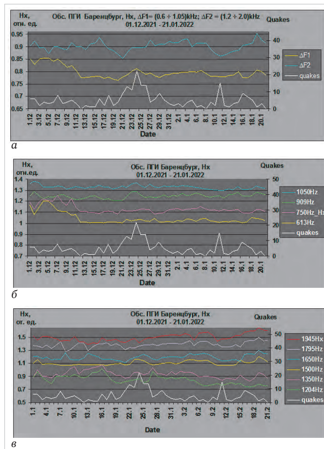
Рис. 5. Синхронная запись АЧХ магнитной H_x -компоненты поля атмосфериков (обс. ПГИ Баренцбург, арх. Шпицберген) и сейсмической активности «quakes» (Kahramanmaras, Turkey): а) \Delta F1 = (0,6 \div 1,05) кГц – поверхностные волны п. а., \Delta F2 = (1,2 \div 2,0) кГц – пространственные волны п. а.; б) АЧХ поверхностных волн п. а., частотное разрешение \Delta f = 200 Гц; в) АЧХ пространственных волн п. а., частотное разрешение \Delta f = 200 Гц
