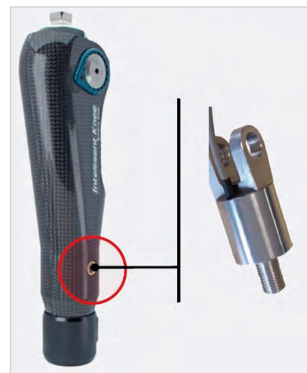
Рис. 3. Вид на датчик усилия фирмы Scaime и место его расположения в ортопедическом протезе
