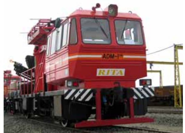
Рис. 11. Экспортный вариант путевой машины АДМ-1см на железных дорогах Испании
