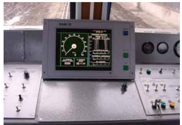
Рис. 10. БОИО и панели управления, встроенные в системный пульт путевой машины
