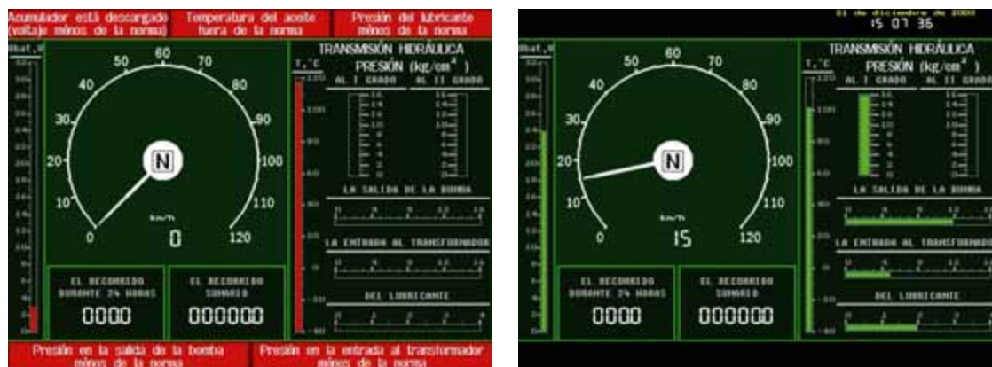
Рис. 8. Рабочий экран АСК-3И (выставлены аварийные сообщения: значения давления равны нулю, температура превышает норму, упало напряжение аккумуляторной батареи)
