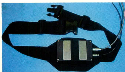
Рис. 14. Оценочный набор модуля GuoDRM, встроенный в пояс, в водозащитном исполнении
