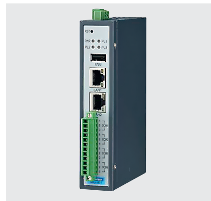
Рис. 3. Интеллектуальный шлюз данных серии ECU-1100
