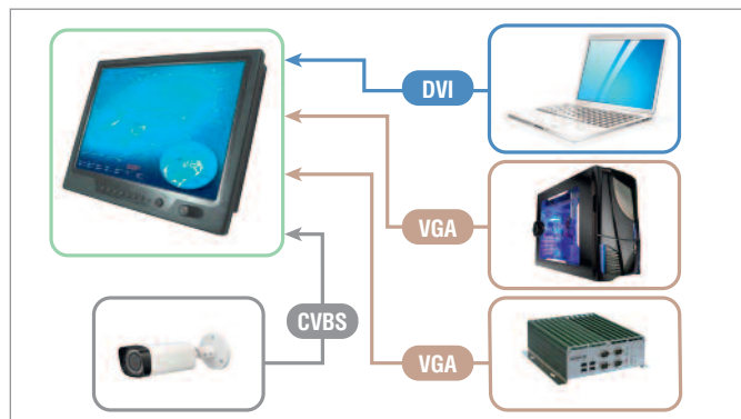
Рис. 18. Подключение нескольких источников видеосигнала
