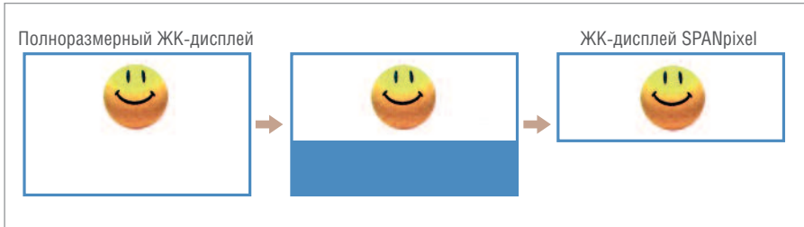
Рис. 10. Отображение подготовленного медиаконтента с учётом особенностей ЖК-дисплея SPANpixel
