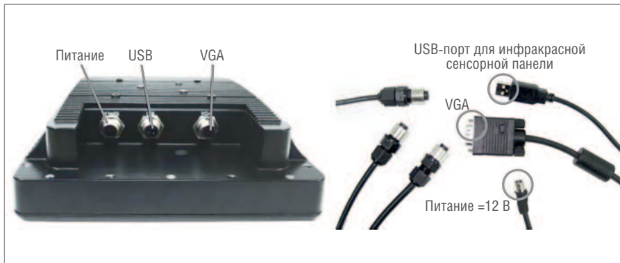
Рис. 16. Монитор NPD0835: коннекторы и кабели
