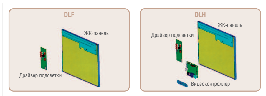
Рис. 4. ЖК-дисплеи серии DURApixel: варианты конструкций DLF и DLH
