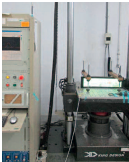
Рис. 7. Стенд испытаний на ударопрочность
