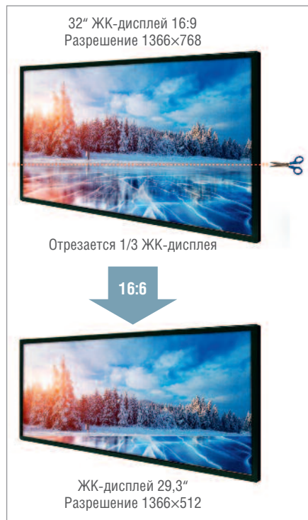
Рис. 6. Преобразование ЖК-дисплея формата 16:9 в формат 16:6
