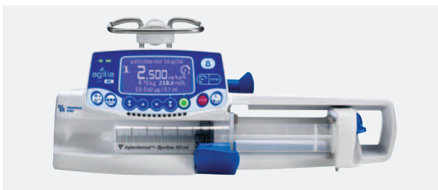
Рис. 14. Шприцевой насос с контролем параметров введения препаратов пациентам
