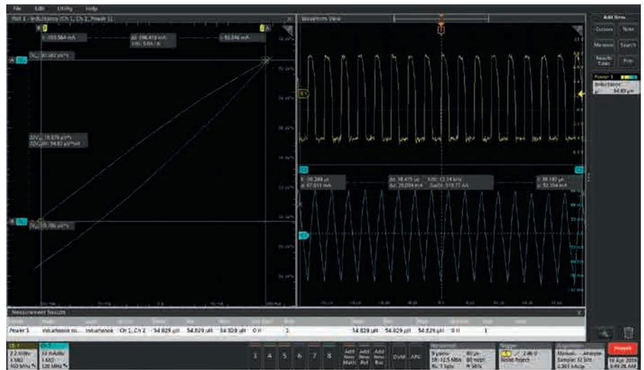
Рис. 2. Измерение среднего значения индуктивности, Гн
