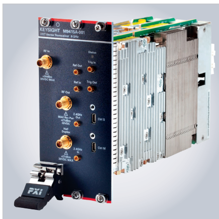
Рис. 6. Высокопроизводительный векторный трансивер M9415A VXT является основой нового решения S9130A
