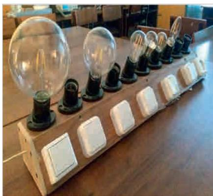
Рис. 1. Внешний вид филаментных ламп разных габаритов и мощностей
