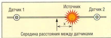
Рис. 1. Пространственная структура трубы с источником шумового сигнала и с двумя приёмными датчиками
