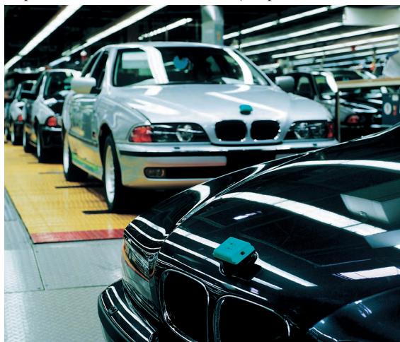
Микроволновая система идентификации IDENT-M System V в сборочных цехах автомобильного концерна BMW
