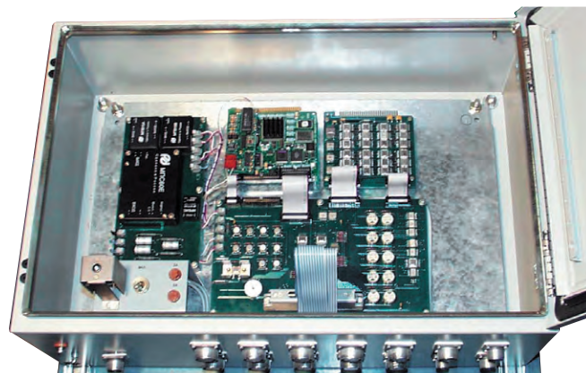
Рис. 7. Устройство накопления и обработки информации УНО-84П
