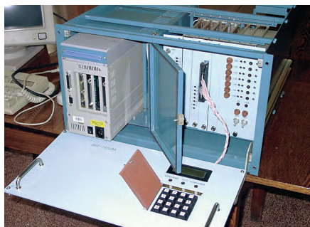
Рис. 9. Унифицированная блочно-модульная конструкция БОИ-7652М
