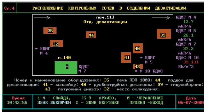
Рис. 3. Мнемосхема отделения дезактивации
