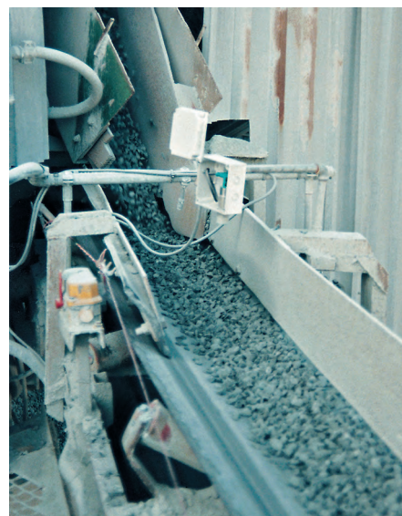
Ультразвуковые датчики способны работать в сложных условиях
