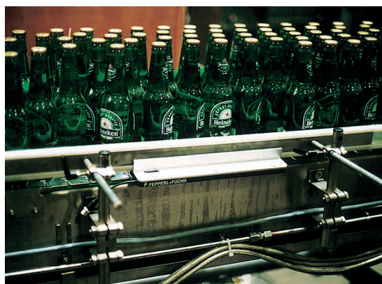
Фотоэлектрические датчики на заводах KRONES
