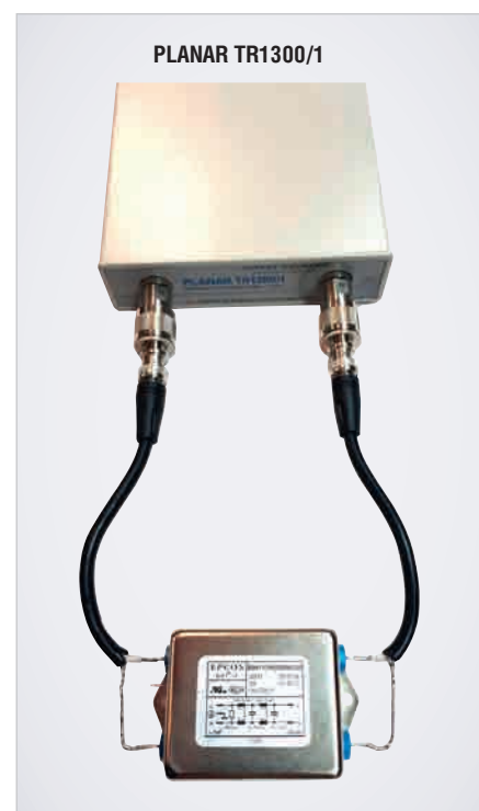
Рис. 2. Измерение затухания фильтра в дифференциальном режиме с помощью векторного анализатора цепей типа PLANAR TR1300/1, подключаемого к фильтру с помощью коаксиального кабеля типа RG58C с волновым сопротивлением 50 Ом
