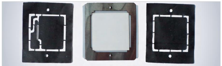
**Рис. 11. Заготовки металлизующей плёнки с топологическими рисунками и оправка с керамической подложкой (в центре)**
