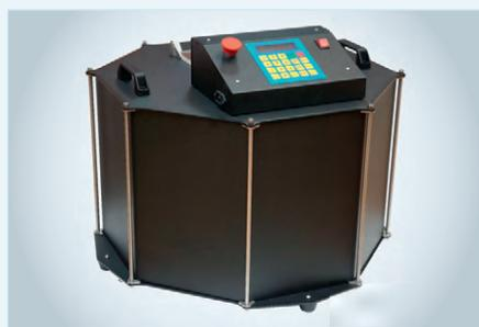
Он представляет собой центрифугу, содержащую вращающееся коромысло, на одном конце которого закреплён наклонный держатель банки с паяльной пастой, а на другом – автоматически регулируемый противовес.
