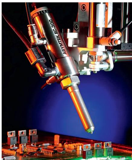
Рис. 1. Нанесение защитных покрытий на печатные платы
