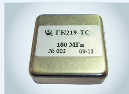
Показатели температурной нестабильности частоты достигают  $5 \times 10^{-8}$  в широком интервале рабочих температур. Долговременная стабильность частоты обеспечивается на уровне до  $3 \times 10^{-7}$ /год. ГК219-ТС имеет малое время установления частоты (<5 мин), синусоидальный выходной сигнал и напряжение питания 12 В.
