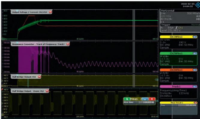
Рис. 2. Характеристика включения резонансного преобразователя
