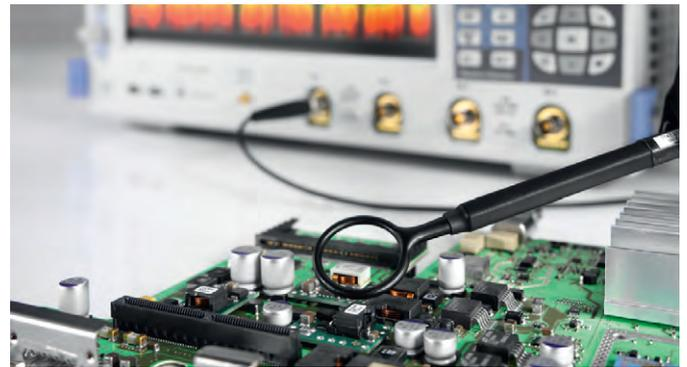
Рис. 3. Локализация источников нежелательных выбросов ЭМП с помощью пробников ближнего поля
