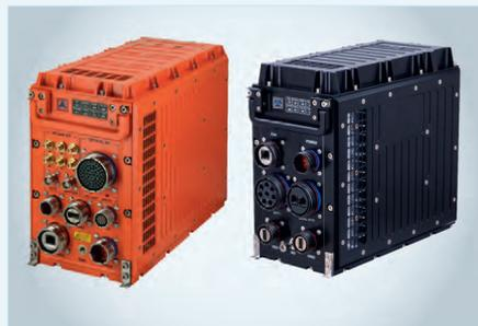
Корпуса CM-ATR-3U выпускаются в четырёх вариантах: на 3, 5, 7 и 9 слотов с соответствующей рассеивающей способностью 320, 400, 450 и 500 Вт. Шаг установки модулей – 1 дюйм. Объединительная панель (backplane) может быть 3U VPX или cPCI-S (CompactPCI Serial).
