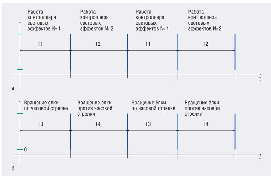
Рис. 2. Временная диаграмма работы устройства: а) интервалы работы, задаваемые РВ № 1; б) интервалы работы, задаваемые РВ № 2
