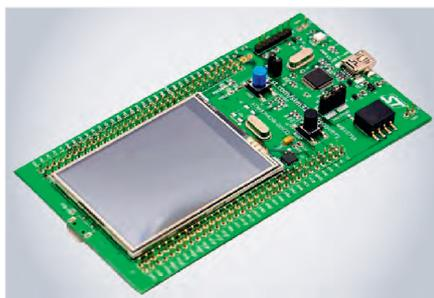
Рис. 1. Отладочная плата 32F429IDISCOVERY
