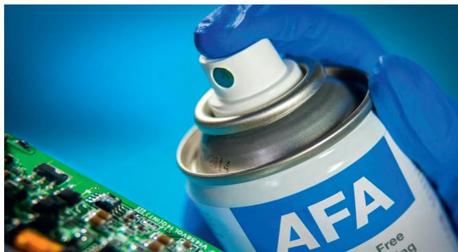
Рис. 3. Нанесение покрытия AFA на печатную плату
