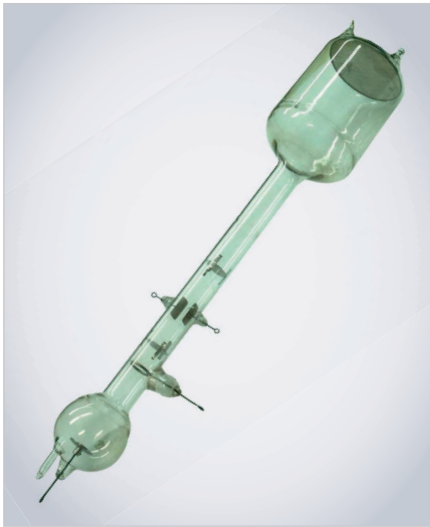
Рис. 6. Приёмная трубка Розинга для «Телефота», 1907 год
