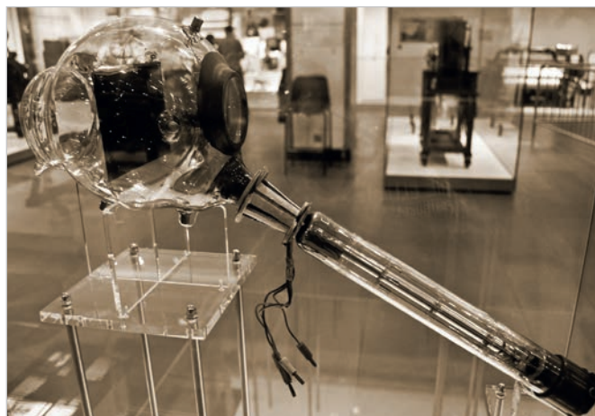
Рис. 5. Усовершенствованный иконоскоп В.К. Зворыкина
