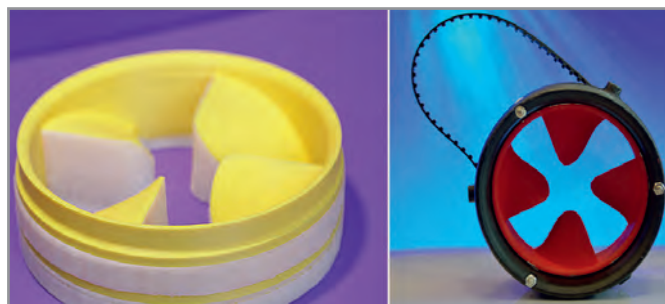
Рис. 4. Спроектированные модели гребного винта, напечатанные на 3D-принтере
