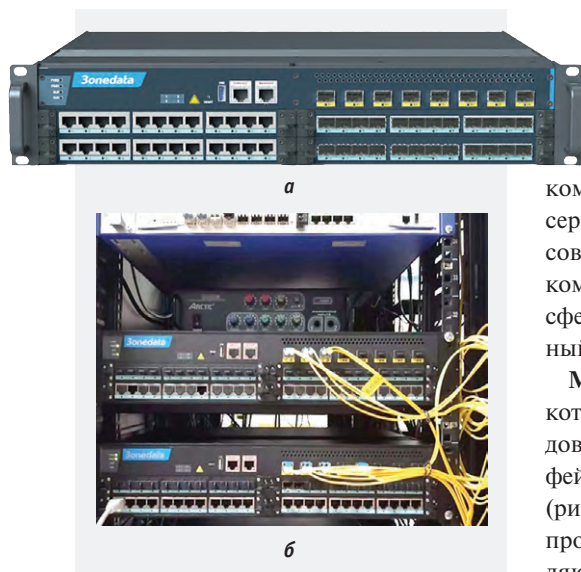
Рис. 6. Коммутатор Zonedata ICS5556 уровня L3 для ядра сети: внешний вид (а); установка на объекте (б)
