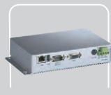
UNO-2052 GX1-300 Встраиваемый контроллер с 2xCAN, Ethernet, USB, RS-232, 8xDIO (изоляция), 2xAI
