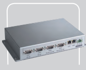
UNO-2160/UNO-2170 Celeron® 400/ Celeron® M Встраиваемый контроллер с шиной расширения PC/104
