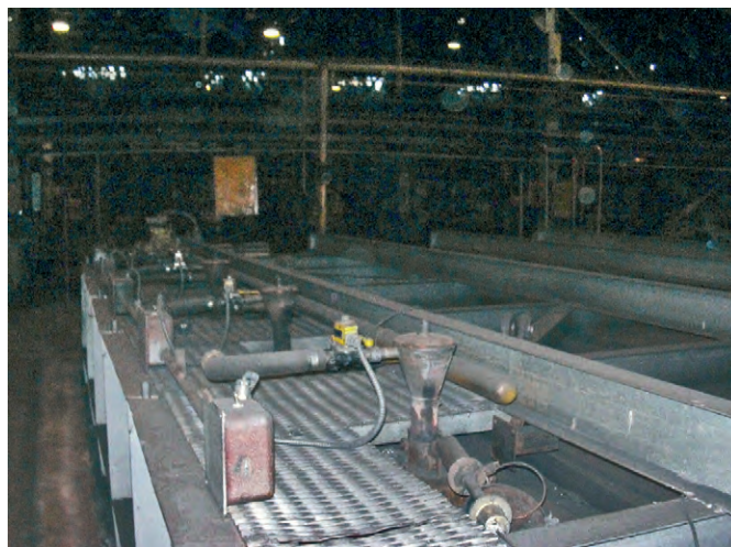
Рис. 2. Рампа обжиговой камеры с органами управления
