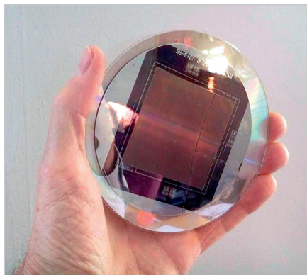
Рис. 11. 1980 год. 16 Мп CCD-датчик для станции Вояджер
