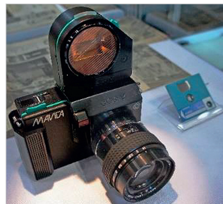
Рис. 5. Sony Mavica NTSC 570×490 – первая коммерческая видеокамера с аналоговой памятью
