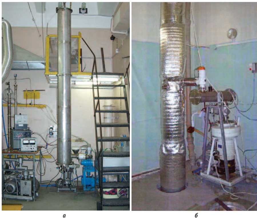
Рис. 7. Два варианта экспериментальной колонны: с высотой насадочной части 2 м (а) и фрагмент 18-метровой колонны в месте сопряжения с блоком вакуумирования теплозащитной оболочки (б)
