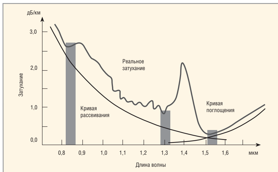
Рис. 3. Окна прозрачности оптических кварцевых волокон
