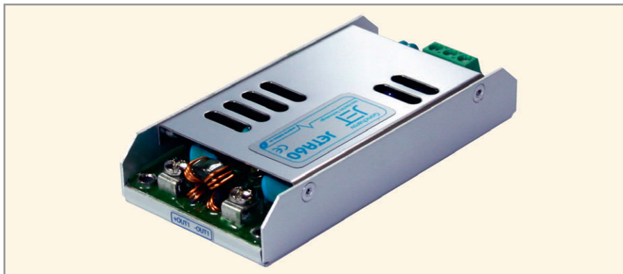
Рис. 4. AC/DC-модуль JETA60 (прототип модуля электропитания с ККМ для ППМ АФАР с \Delta L = 47 мм, габариты 101 \times 51 \times 18 мм)
