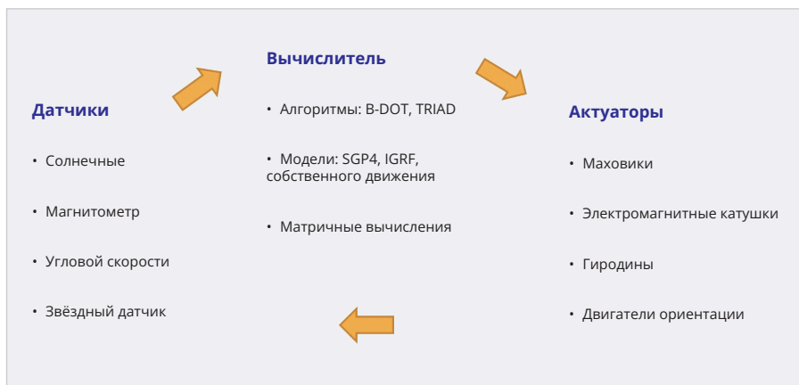
Рис. 5. Принцип работы и основные элементы системы ориентации и стабилизации (СОС) в развёрнутом виде на испытаниях
