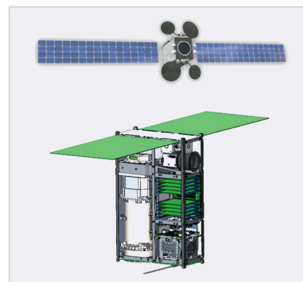
Рис. 6. Внешний вид и схема расположения отсеков малого спутника
