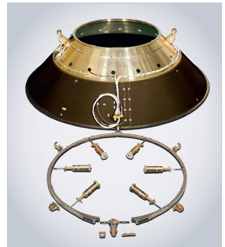
Рис. 16. Типичный адаптер космического аппарата
