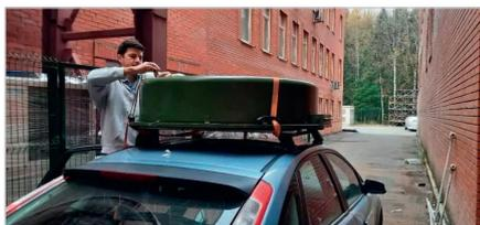
Рис. 13. Антенна SOTM, установленная на крыше автомобиля
