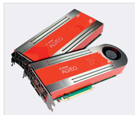
Рис. 4. Ускорители Xilinx Alveo Data Center представляют собой компактные сетевые адаптеры SmartNIC, которые ускоряют динамические рабочие нагрузки, адаптируясь к постоянной оптимизации алгоритмов быстрее, чем акселераторы с фиксированными функциями
