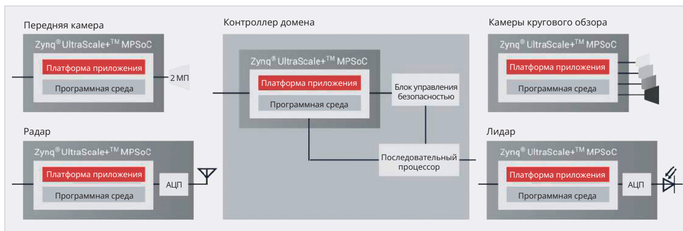
Рис. 2. Возможность агрегации, предварительной обработки и распределения данных (DAPD) улучшает обработку ИИ за счёт объединения данных датчиков и подготовки их к обработке модулями производительности
