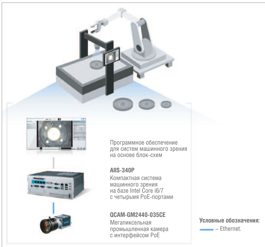
Рис. 7. Структура интеллектуальной системы машинного зрения VisionNavi
