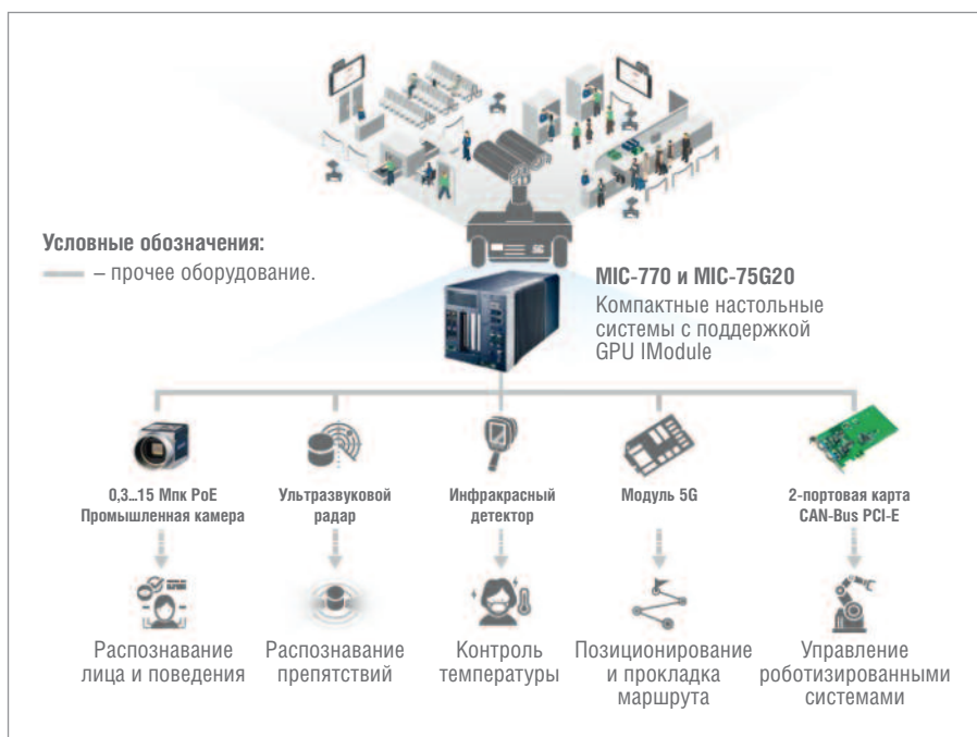
Рис. 4. Структурная схема системы ИИ и машинного зрения патрульного робота
