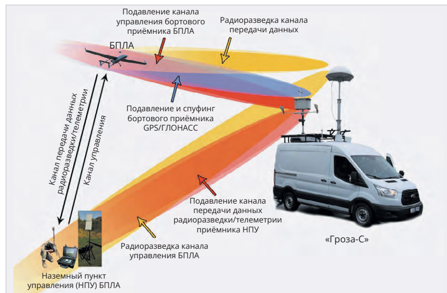
Рис. 7. Варианты воздействия на БПЛА разных сигналов с Земли под контролем системы РЭБ типа «Гроза-С» в гражданском и военном вариантах
