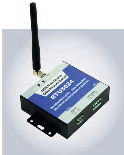
Рис. 11. Внешний вид GSM-контроллера RTU5024
