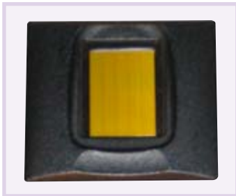
Рис. 4. Ёмкостный сканер отпечатков пальцев
