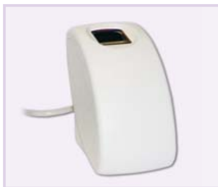
Рис. 2. Внешний вид контрольного дактилоскопического считывателя отпечатков пальцев
