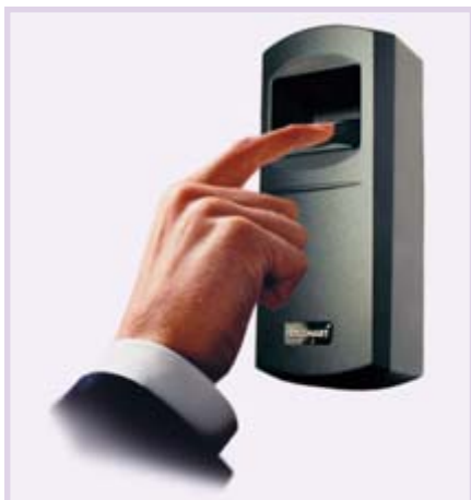
Рис. 1. Дактилоскопический считыватель отпечатков пальцев «BioSmart»
