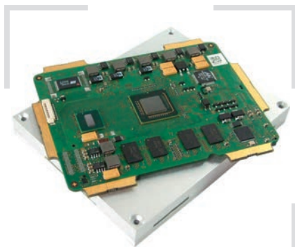
Рис. 7. Модули Rugged COM Express (VITA 59)
