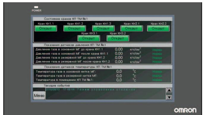
Рис. 8. Экран управления кранами системы телемеханики КПТМ № 1
