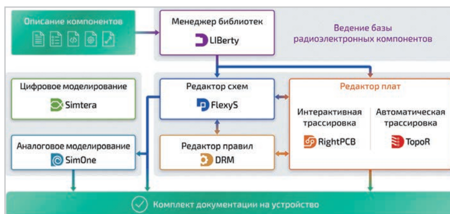
Рис. 1. Цикл проектирования печатной платы
