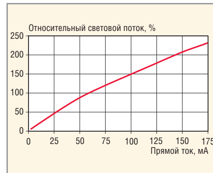
Рис. 14. Зависимость относительного светового потока светодиодов MX-6S от прямого тока
