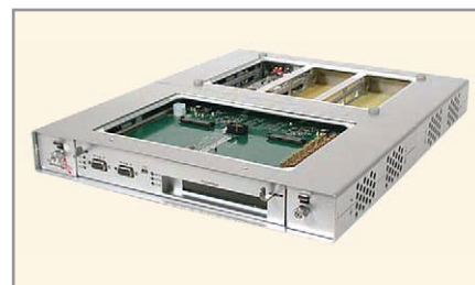
Рис. 7. CEN-PICO-1US – блок платформы MicroTCA в габаритах 4,5 × 33 × 20 см
