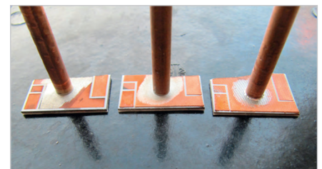
Рис. 9. Фото фрагментов плат силовых модулей с припаянными стержнями для измерения адгезии методом прямого отрыва
