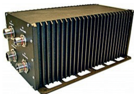
Рис. 6. Корпус CPCI Rack для создания систем с кондуктивным охлаждением на базе форм-фактора 3U CompactPCI
