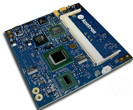
Рис. 5. Модуль microETExpress-SP с системным контроллером-концентратором Intel SCH US15W, рассчитанный на процессоры серии Intel Atom Z5xx
