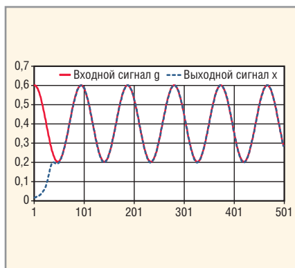
Рис. 6. Сигналы в адаптивной системе с линейризованной амплитудной характеристикой (u = w 0 g)
