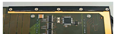
Рис. 3. Теплопроводящая окантовка, проходящая по границе печатной платы [2]
