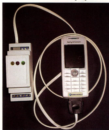
Рис. 2. Регулятор температуры с сотовым телефоном T630 (модуль устанавливается на DIN-рейку)
