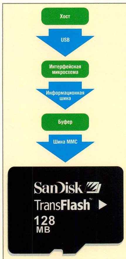
Рис. 1. Диаграмма следования данных в USB-записи
