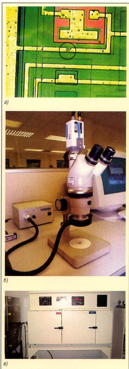
Рис. 3. Пустоты в металлизации (а), стереомикроскоп в составе автоматизированного рабочего места РФА (б) и стенд квалификационных испытаний (в)
