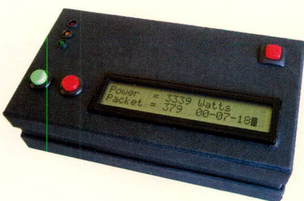
Рис. 6. Приёмная часть измерительного устройства с отображением информации на ЖКИ
