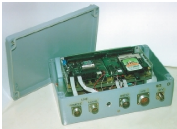
Внешний вид узловой станции
